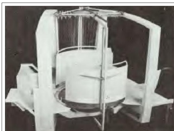
A articulação com giro total de 51 graus. (Revista "Transporte Moderno" - março/1987)
