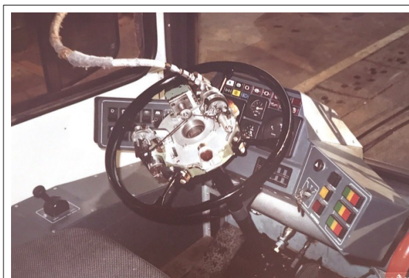
Painel de comando do protótipo do trólebus padron Mafersa: o equipamento na direção utilizou sensores para analisar o acionamento do volante e as vibrações da via, para eventuais melhorias no sistema de direção. (Acervo Mafersa)
