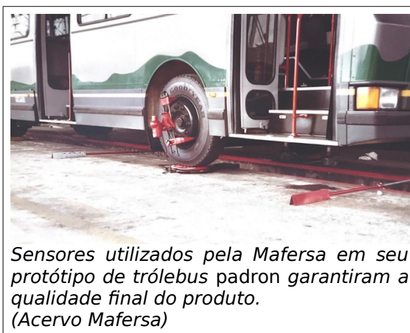
Testes de vibração e desempenho do protótipo realizados pela fábrica. (Acervo Mafersa)
