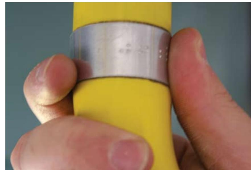
Em todos os ônibus da CTA foram instalados anéis com a identificação da linha em braille.
